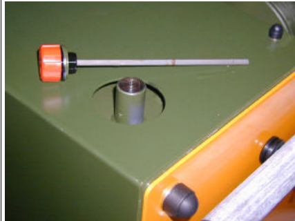
Hydrauliktank mit Peilstab
